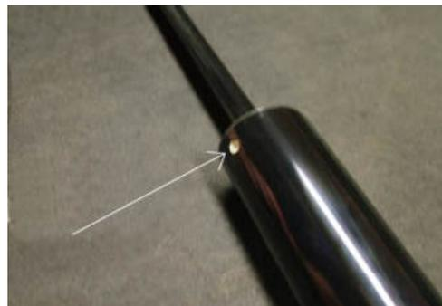
4. Kabel-Zugentlastung lösen
