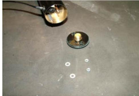
2. mittels zugesandtem Steckschlüssel die beiden Muttern im Schaftende lösen
